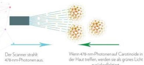
Der Scanner strahlt 478-nm-Photonen aus.
